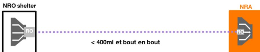
La connexion de la FOP NRO-NRA est réalisée par le RIP qui met à disposition de l'Opérateur un connecteur sur le RO de chaque extrémité.
